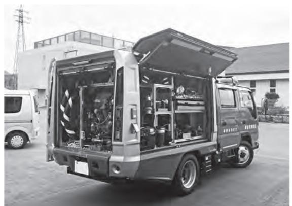
救助資機材搭載型小型動力ポンプ積載車
