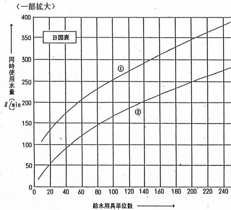
図 2-2 ウェストン公式による流量図
