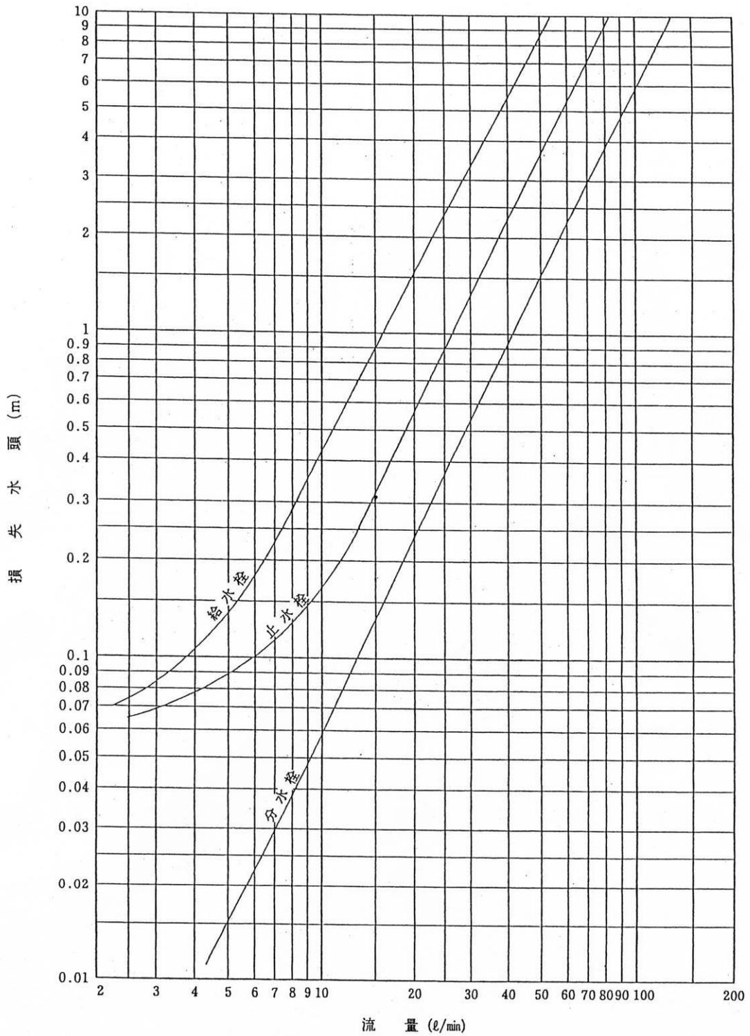
图 2-6 分水栓·止水栓·给水栓流量图表 (25mm)
