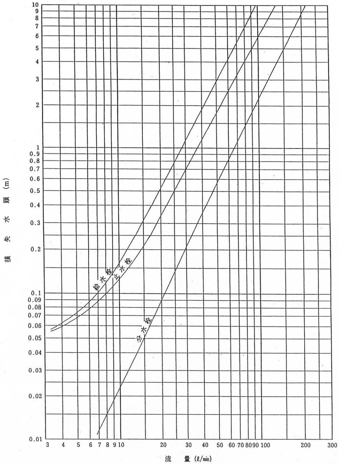
図 2-7 ボールタップ流量図表 (20~75mm)
