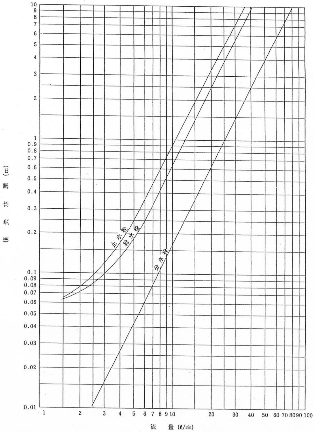
图 2-5 分水栓·止水栓·给水栓流量图表 (20mm)
